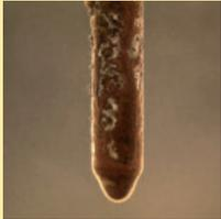
Korrosion mit herkömmlichem Diesel<sup>1</sup>
