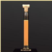
Wasser-Diesel-Mix mit herkömmlichem Diesel<sup>1</sup>
