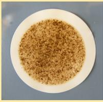
Mikrobenwachstum mit herkömmlichem Diesel<sup>1</sup>
