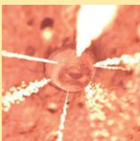
Spritzbild verschmutzte Einspritzdüse mit herkömmlichem Diesel<sup>1</sup>
